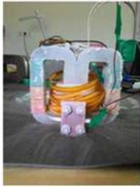
Şekil 3.9 Süperiletken polikristal YBCO halka üzerine 13 sarımlı süperiletken tel
