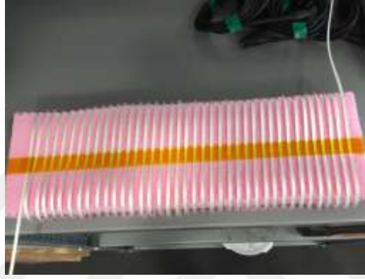
Şekil 3.10 Rezistif SHAS için hazırlanan süperiletken tel (tek faz)
