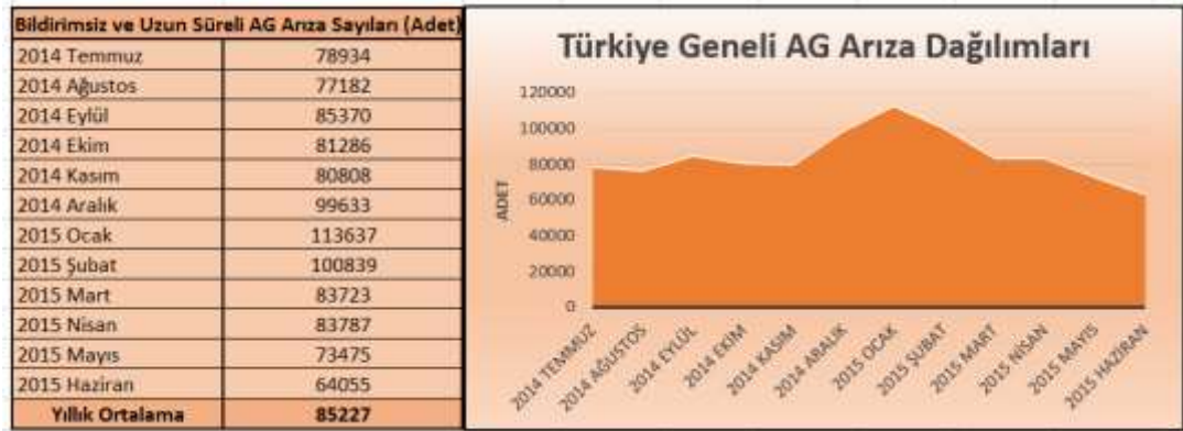
Şekil 1.3 Dağıtım şirketlerinin trafolarına etki eden alçak gerilim arızalarının dağılımı
