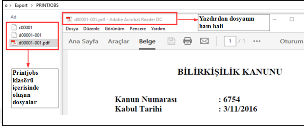
Şekil 3.36. Mac_apr.exe’nin çalıştırılması sonucu PRINTJOBS klasörü altında oluşan dosyalar ve yazdırılan dosyanın ham hali.
