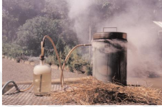
Şekil 2.1 Dumanla doymuş su üretmek için geliştirilen aparat (Van Staden vd. 2004)
