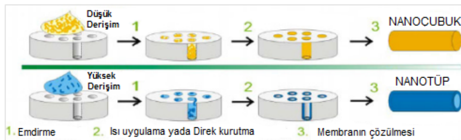
Şekil 1.10. Membranı ıslatmada polimer çözeltisinin düşük veya yüksek konsantrasyonda olmasının etkisi (Massuyeau ve ark., 2009)
