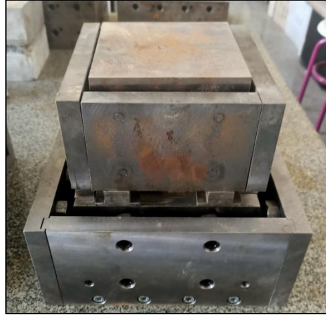
Şekil 3.7 Kaya üst bloğunun yerleştirilmesi ve bloğu kuşatacak çelik plaka desteklerinin dizilimi
