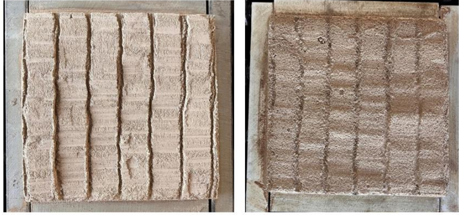
Şekil 3.19 Üç mm kalınlıkta serilmiş kuru kil (solda) ve büzülme limitine getirilmiş kil (sağda)
