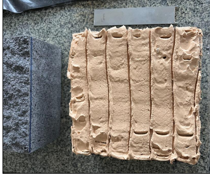
Şekil 3.20 Sert-1 dolgu uygulanarak kalınlık ayarlaması yapılmış alt blok (yapay düzlem boyutları 15 cm x 15 cm’dir)
