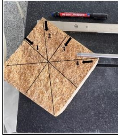
Şekil 3.13 Ölçüm için farklı yönlerden alınan süreksizlik profillerinin şeması
