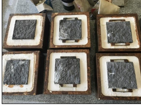
Şekil 3.5 Klasik deney yönteminde alçı ile doldurulup sabitlenen kaya örnekleri (numune boyutları 15x15 cm)
