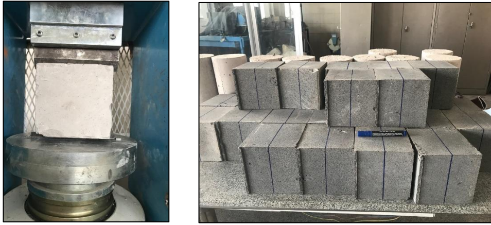
Şekil 3.9 Baltalı pres düzeneğinde kübik numunelerde yapay süreksizlik oluşturulması (solda) ve kılavuz hat çizilmiş numuneler (sağda)
