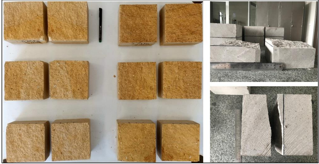
Şekil 3.10 Deney için kullanılabilir (solda) ve konkav/konveks kırılmış yüzeylere ait görüntüler (sağda) (numune ebatları 15 cm’dir)
