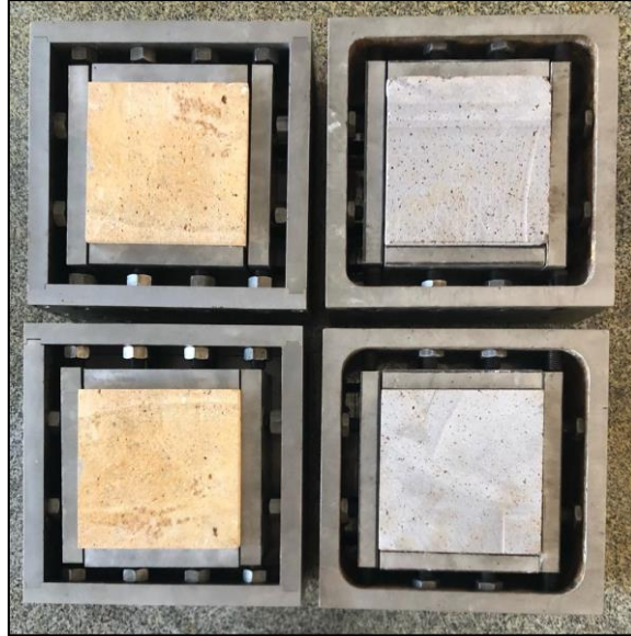
Şekil 3.6 Ayar vidaları ve çelik destekler yardımıyla istenilen boyutta numune sabitleyebilen kalıplar ve numunelerin sabitlenmiş görünüşleri (numune boyutları 15x15 cm)
