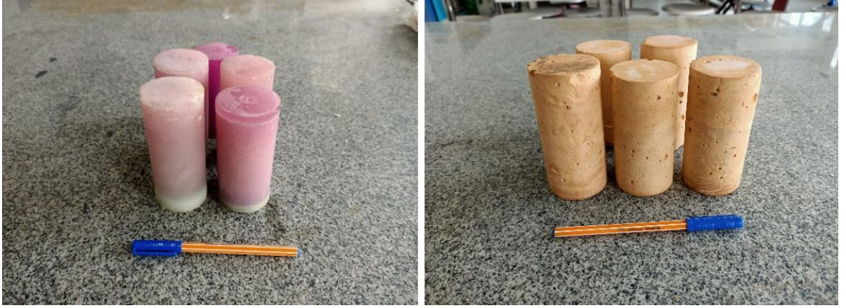
Şekil 3.25 Reçine (solda) ve alçı (sağda) dolgu malzemelerinden hazırlanan deney numuneleri
