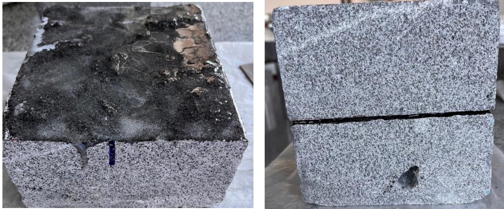
Şekil 3.28 Süreksizlik yüzeyine sert-2 dolgu uygulanmış numuneler
