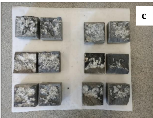
Şekil 4.1 Doğrudan kesme deneyi sonrası a) yumuşak dolgu, b) sert-1 dolgu ve c) sert-2 dolgu uygulanmış numunelere örnekler
