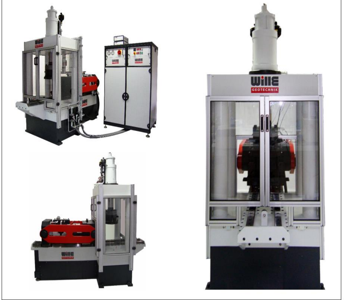
Şekil 3.8 Çalışmada kullanılan kesme deney cihazından değişik görünümeler
