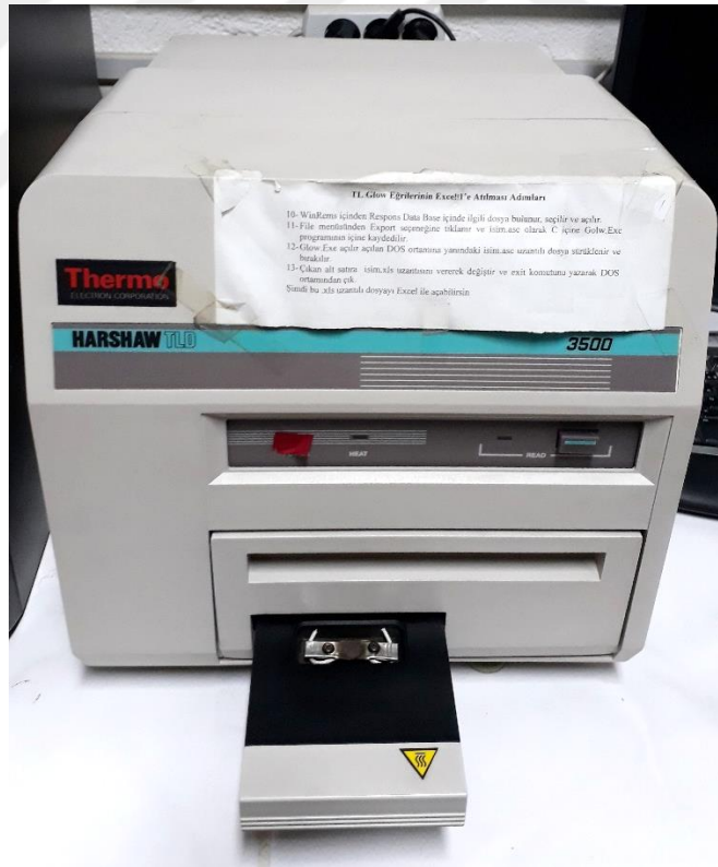
Şekil 3.4 Harshaw 3500 TLD okuyucu
