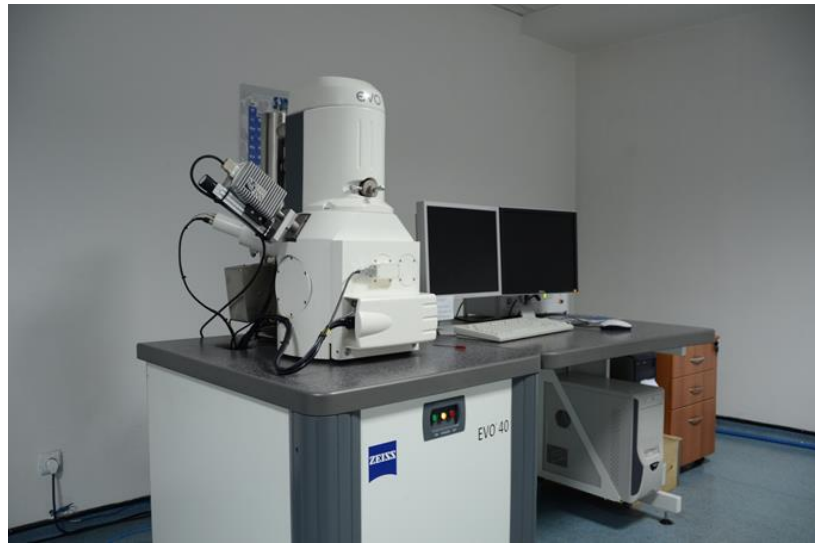
Şekil 3.6 Zeiss Evo 40 SEM sistemi
