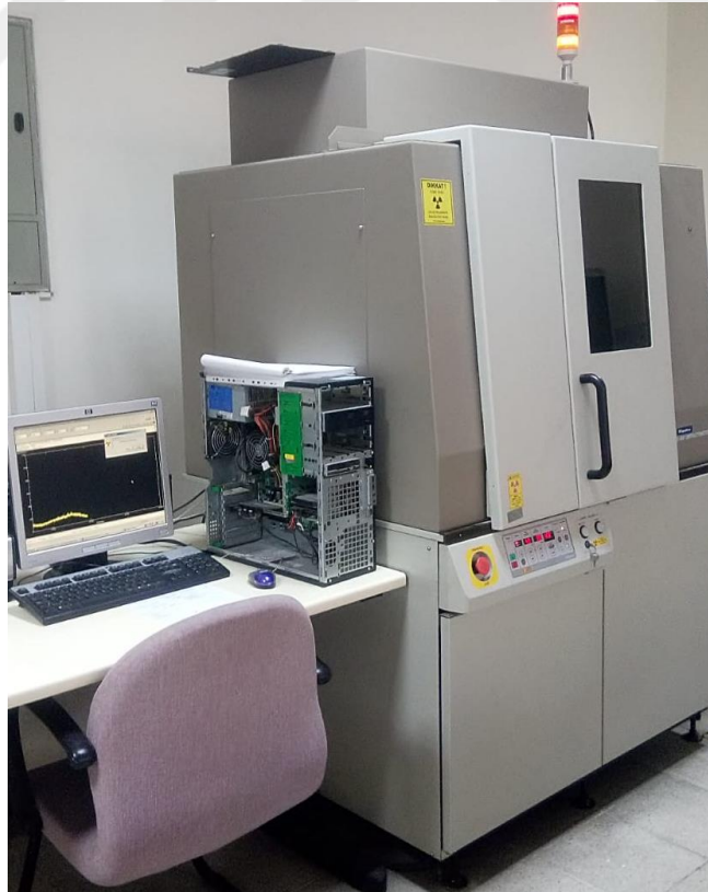
Şekil 3.7 Rigaku D/Max 2200 PC XRD spektrometre sistemi
