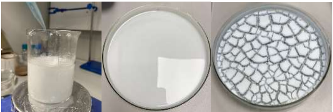
Şekil 3.3 Sol-jel yöntemiyle 29S29B mezoporöz biyoaktif cam sentezi
