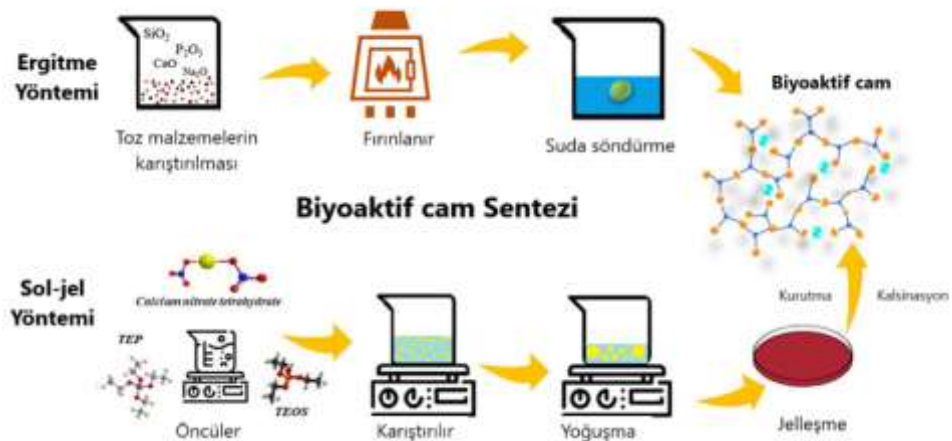
Şekil 2.28 Sol- jel yöntemiyle biyoaktif cam sentezi
