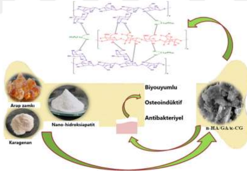
Şekil 2.20 Nano-hidroksiapatit (n-HA), arap zankı (GA)/ \kappa -karagenan ( \kappa -CG) içeren üçlü bir sistem üretimi (Mirza vd. 2020)
