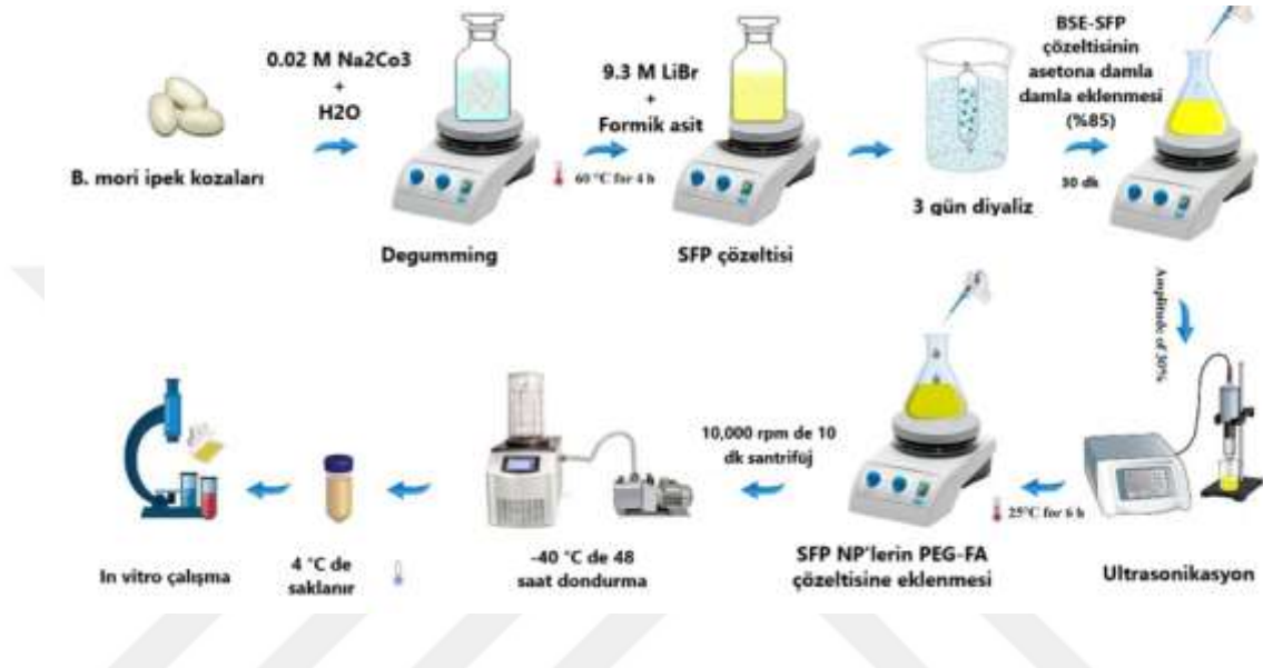
Şekil 2.16 PEG-FA-SFPNP'lerin hazırlanmasının şematik gösterimi (Ghanbari Hassan Kiadeh vd. 2024)
