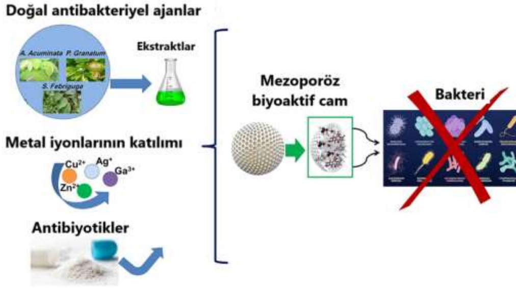
Şekil 2.26 Çeşitli metal katyonların MBG yapısına dâhil edilmesinin ve bakteriyel üremenin engellenmesinin şematik gösterimi (Kargozar vd. 2018)
