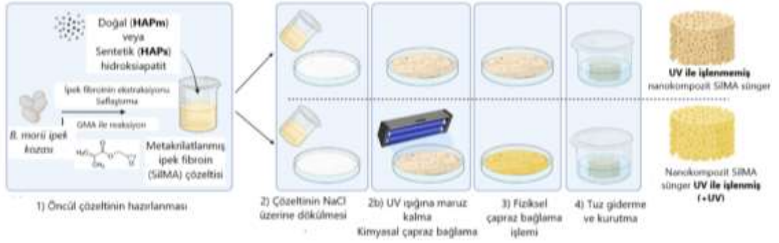
Şekil 2.10 Nanokompozit SilMA sünger üretim sürecinin şeması (Spessot vd. 2024)
