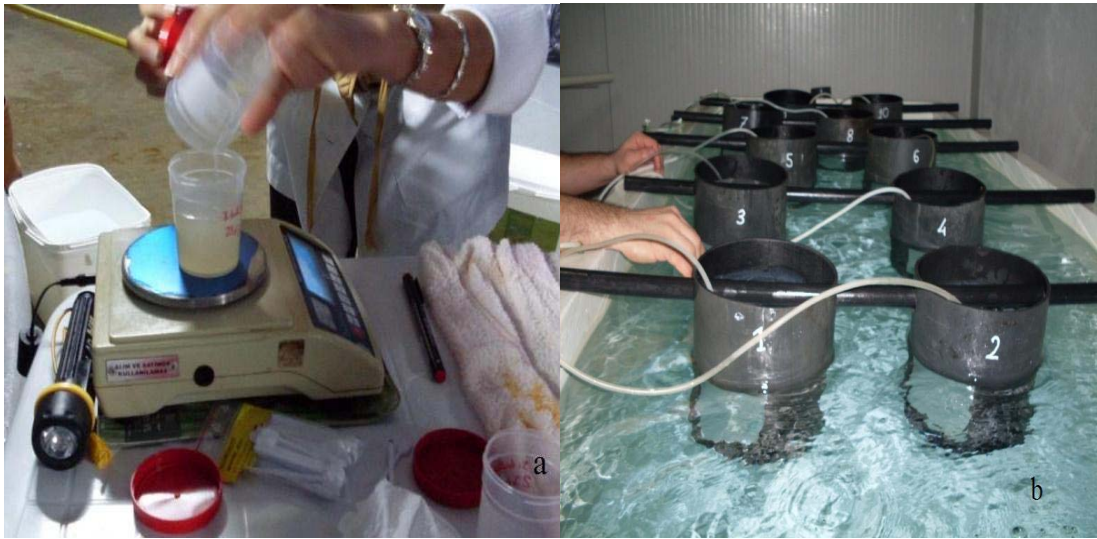
Şekil 2.10. Alınan yumurtaların birleştirilmesi ve inkübatörler. 4 farklı dişiden alınan yumurtaların birleştirilmesi ve elektronik terazi (a), 500 \mu göz açıklığına sahip inkübatörler (b)
