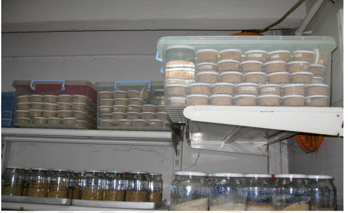
Şekil 3.2 Deneme kaplarının koyulmuş olduğu plastik kutular ve KOH çözeltisi
