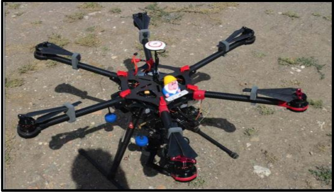
Şekil 4.92 Çalışmalarda kullanılan UAV DJI S-900 (Forte vd. 2015)
