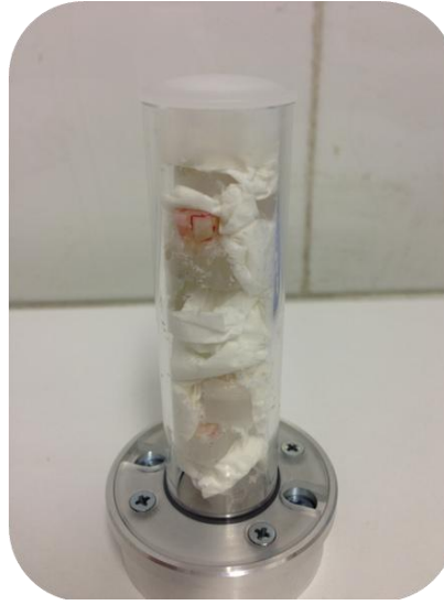
Şekil 2.14 Diş örneklerinin Mikro-BT taraması için 50cc'lik özel tüpe yerleştirilmeleri
