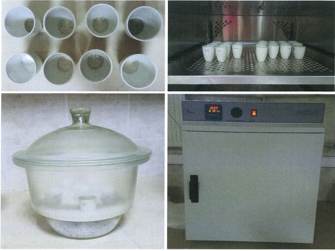
Şekil 3.11 60 °C ve 105 °C’de kurutma esasına dayalı jips tayini
