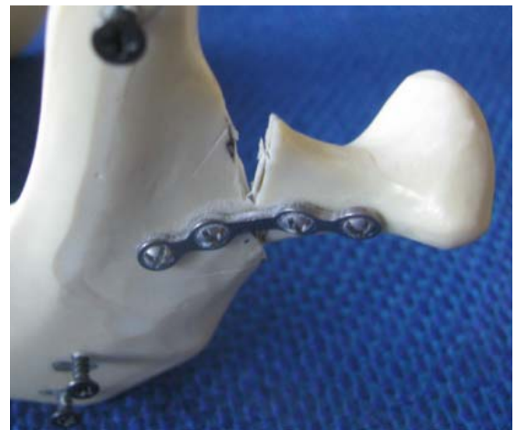
Şekil 3.3. Titanyum plakta görülen kalıcı deformasyona örnekler.
