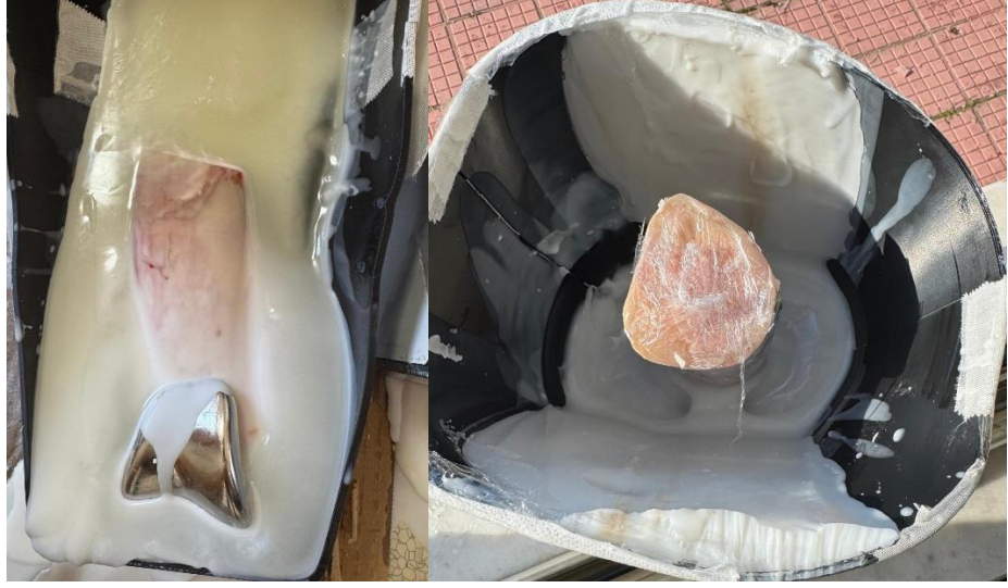
Şekil 3.13 Parafinin 3B baskıya doldurulması ve implantların konumlandırılması
