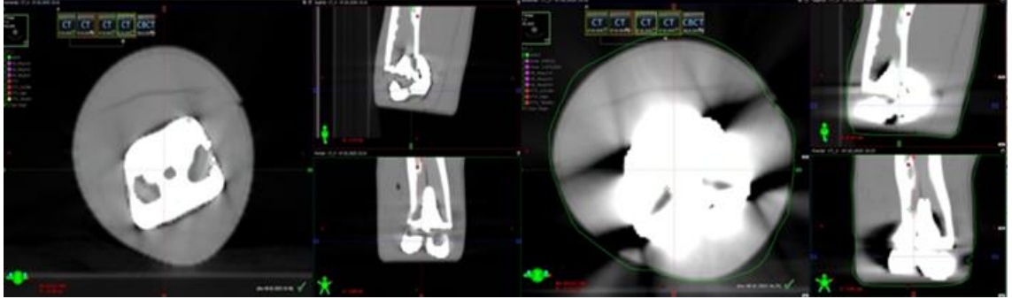
Şekil 3.16 Fantomun CoCrMo implant yerleşimli bölgesinin sırasıyla MAR (+) ve MAR (-) çekilen tomografi görüntüsü
