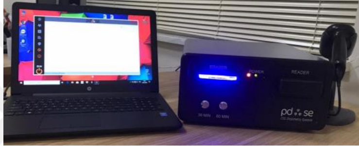
Şekil 3.8 OSL Dozimetre ve Pdose OSL dozimetre okuma sistemi
