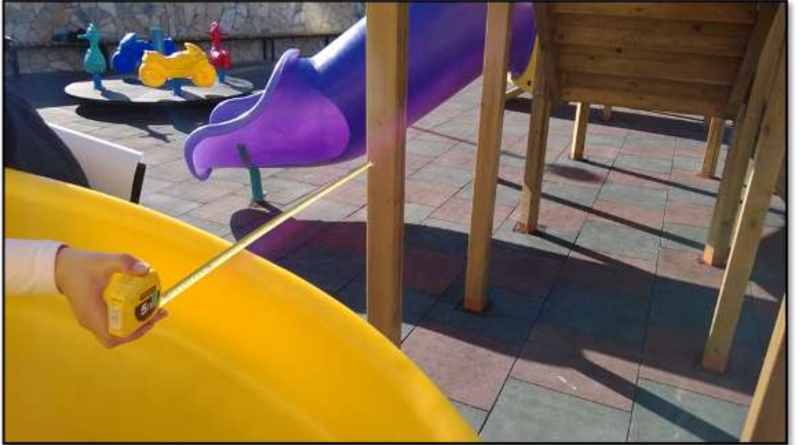
Şekil 4.20 Yatay serbest boşluk ( >1000\text{mm} )
