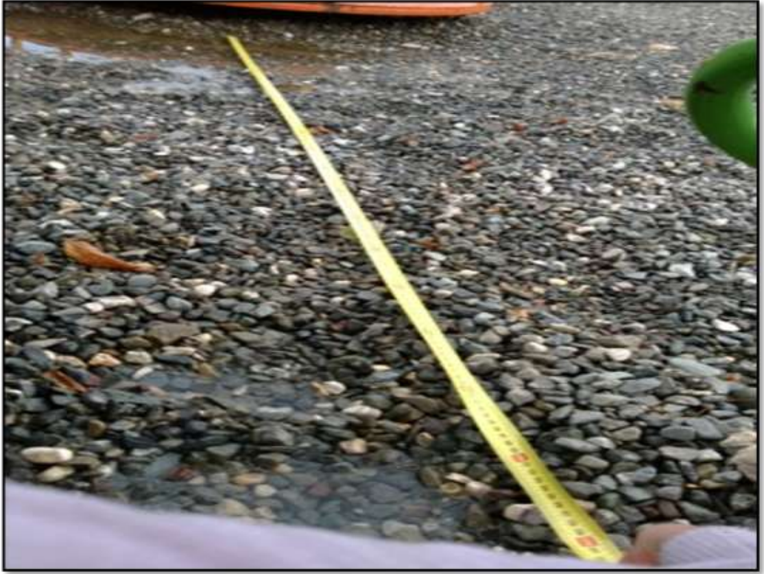
Şekil 4.65 Darbe alanı ölçüsü (atlıkarınca ile yakınındaki oyun alanı elemanı arasındaki mesafe 2100mm)
