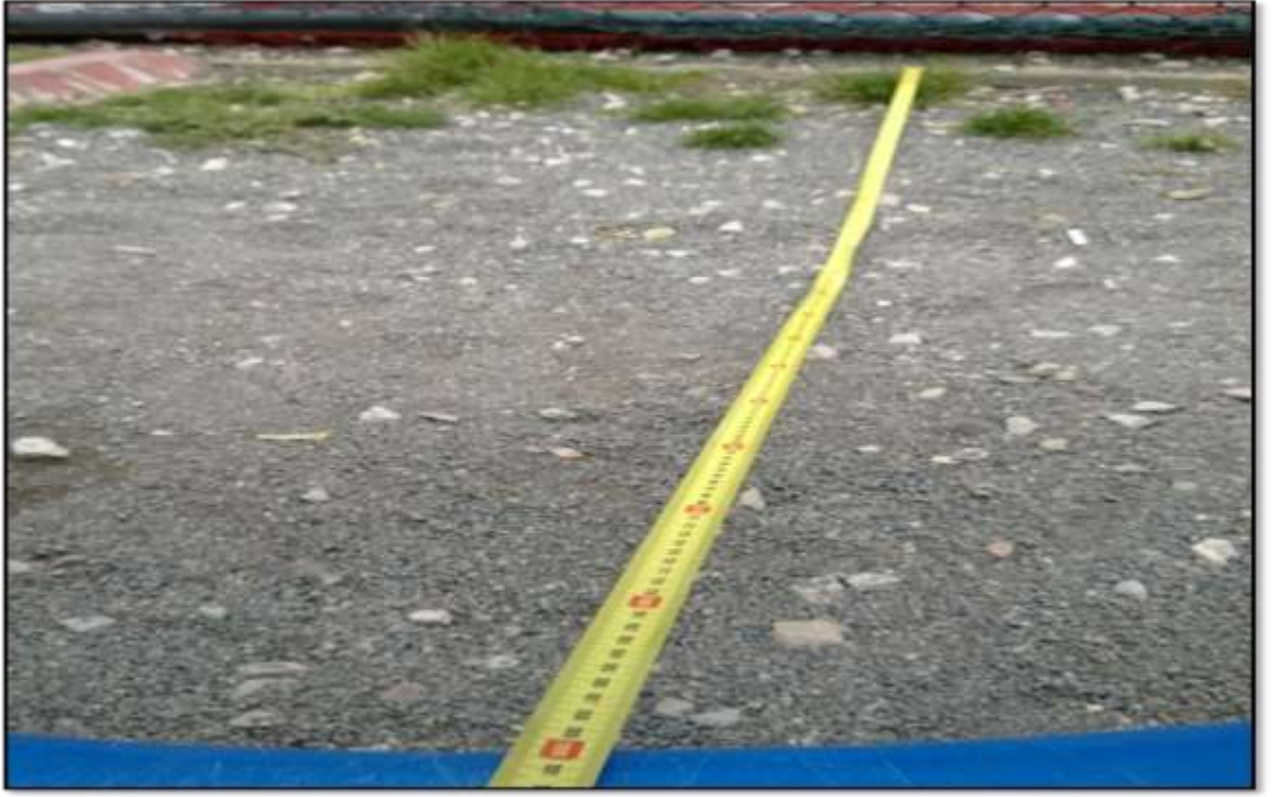
Şekil 4.36 Karışık tünel kaydırak çıkışı ve bordürler arası mesafe (1900mm)
