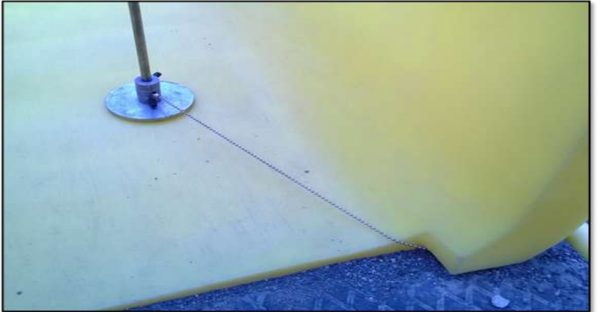
Şekil 4.43 Giysi ve saç yakalama
