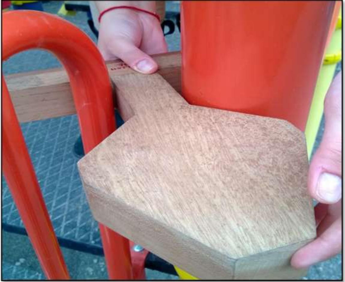
Şekil 4.33 Kısmen kapatılmış açıklıktaki baş ve boyun yakalaması
