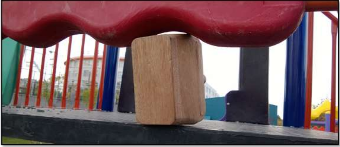
Şekil 4.51 Polietilen korkuluk gövde, baş ve boyun yakalanması
