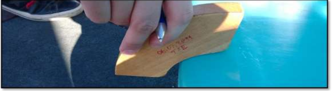
Şekil 4.12 Bağlı kaydırak çıkış bölümü uygunsuzluğu
