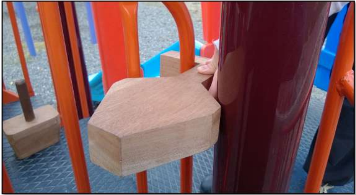
Şekil 4.50 Kısmen kapatılmış açıklıkta yakalanma
