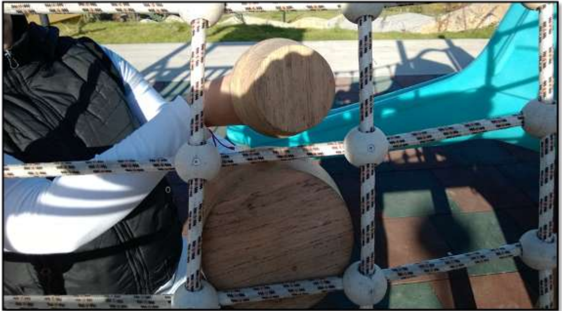
Şekil 4.9 İp köprü baş ve boyun yakalama
