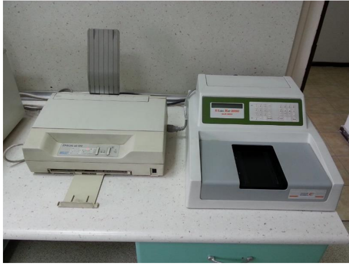
Şekil 2.6 DRG Instruments ELISA-MAT 2000 ELISA kit okuyucu cihaz
