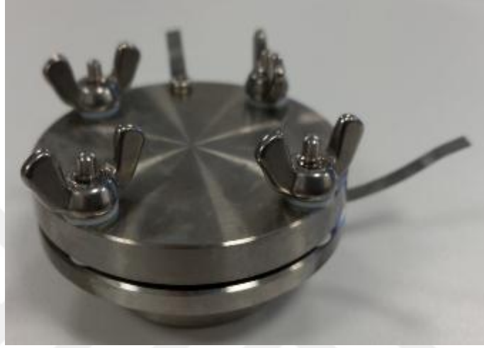
Şekil 3.4 Elektrokimyasal ölçümlerde kullanılan coin cell
