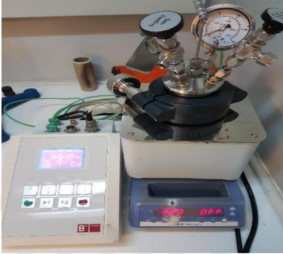
Şekil 3.1 Hidrotermal-solvotermal sentez çalışmalarında kullanılan yüksek basınçlı reaktör sistemi
