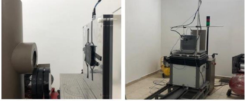
Şekil 3.9 Dozimetrelerin ISO s- 137 Cs gama kaynağı ışınlama sisteminde PTW-H p (10) ve PTW-ISO fantomları kullanılarak kalibrasyonu düzeneği
