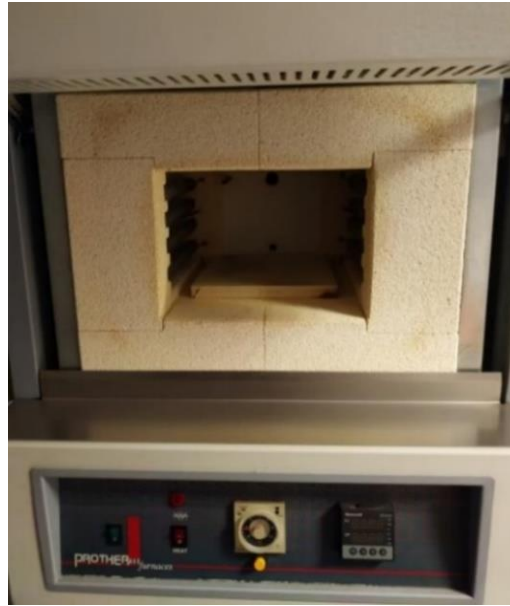
Şekil 3.3 Protherm PFL 110/6 tavlama ünitesi (AÜ NBE)
