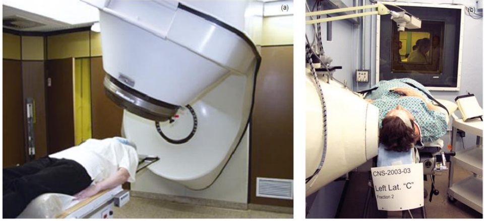
Şekil 2.15 a) Essen Üniversite Hastanesi (Almanya) ve b) Massachusetts Teknoloji Enstitüsü'nde (ABD) gerçekleştirilen BNCT uygulamalarında kullanılan termal nötron ışınlama alanları ve hasta pozisyonu (Sauerwein vd. 2012)
