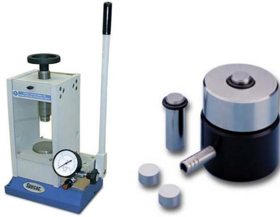
Şekil 3.6 Specac press ve 1,3 cm çaplı kalıp seti
