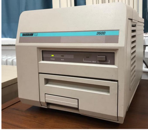
Şekil 3.2 Harshaw 3500 TLD okuyucu (AÜ NBE)
