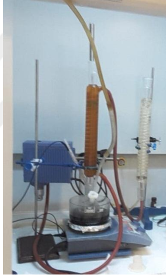
Şekil 3.3 Nanotaneciklerin sentez deney düzeneği
