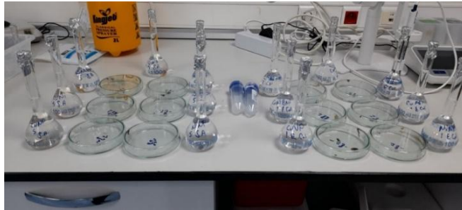
řekil 3.7 Mikrobiyolojik miktar tayini testi
