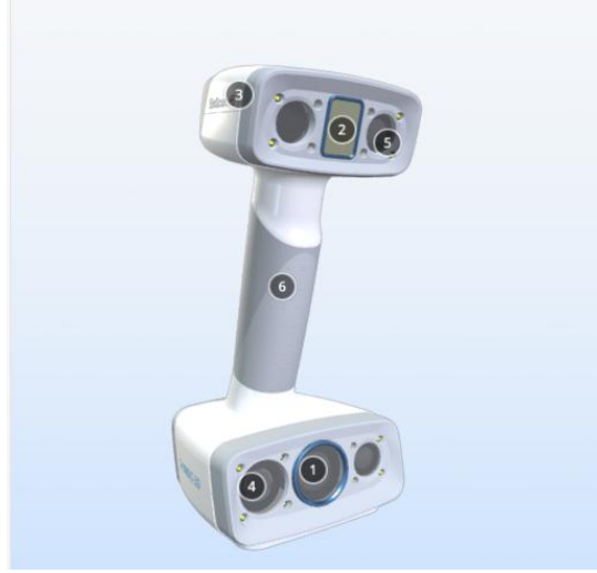
Şekil 3.4.1. EinScan H2 3B Tarayıcı1; 1. 3 adet VCSEL projektör 2. 5 MP doku kamerası 3. Cihaz ölçüm hassasiyeti (0,05 mm'ye kadar) 4. Geniş açılı görüş alanı (FOV) ve ayarlanabilir odak uzaklığı 5. Hibrit ışık kaynağı 6. Ergonomik dizayn (EinScan, n.d.)
