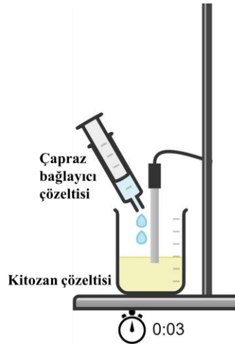
Şekil 2.2 Karboplatin yüklü kitozan nanopartikül üretiminin şematik gösterimi
