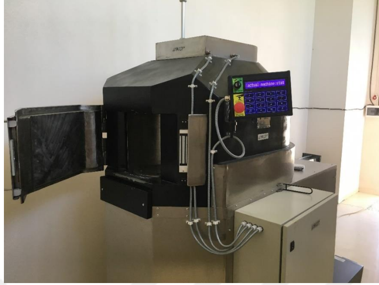
Şekil 2.5. TAEK'te sterilizasyon işleminin gerçekleştirildiği Cobalt-60 kaynağı Gama-Cell cihazı.
