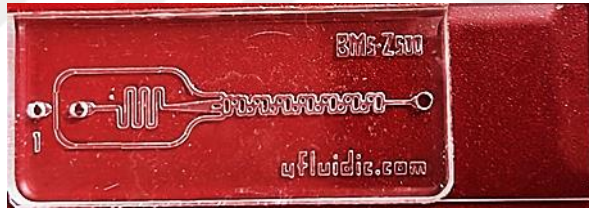
Şekil 2.1. Polimerik nanopartikül formülasyonlarının üretiminde kullanılan PDMS mikroakışkan çipin görseli.
