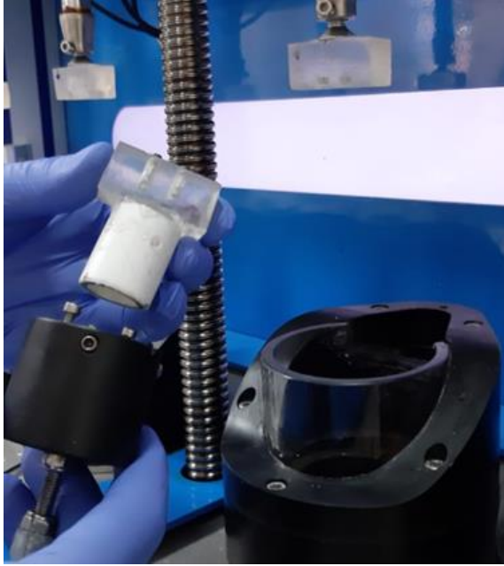
Şekil 2.27. Alt çeneyi simüle eden akrilik blokların çiğneme simülatörüne takılması
