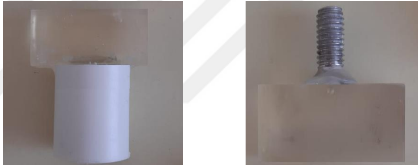
Şekil 2.9. PPRC silindirik boru ve vidanın, şeffaf akrilik bloğa yerleştirilen hali
