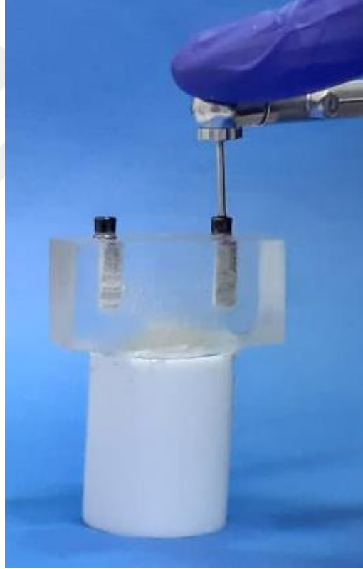
Şekil 2.17. Novaloc dayanakları torklama işlemi
