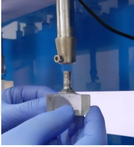
Şekil 2.26. Protezi simüle eden akrilik blokların çiğneme simülatörüne takılması
