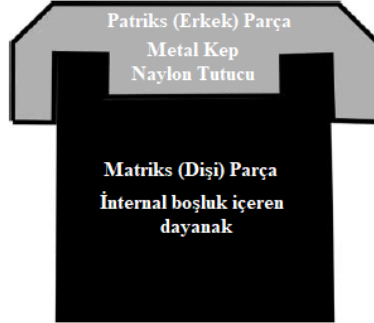
Şekil 1.9. Locator tutucu sistemde, patriks ve matrics yapıları
