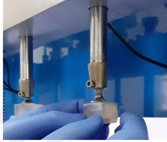
Şekil 2.26. Protezi simüle eden akrilik blokların çiğneme simülatörüne takılması
