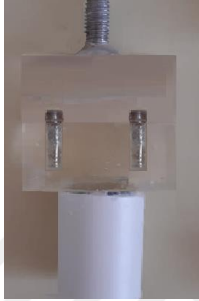
Şekil 2.19. Novaloc dayanak ve titanyum keplerin, polimerizasyon işlemi sonrası görüntüsü
