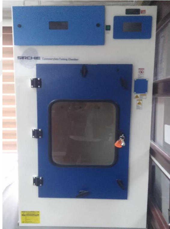
Şekil 2.2. Superglue Uygulama Kabini (Gaziantep, 2017).
