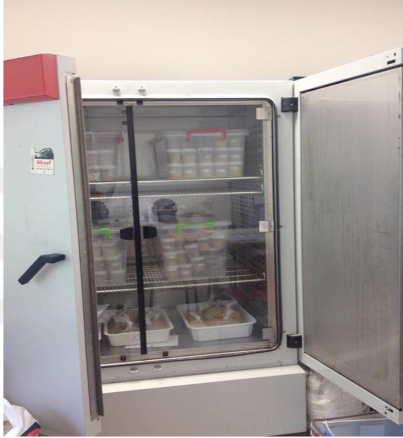
Şekil 3.2 Nem hücreleri ve deneme kapları Binder KB 720 ® marka iklim dolabı içerisinde
