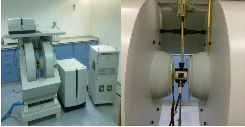
Şekil 3.1 Nükleer Bilimler Enstitüsü laboratuvarında bulunan EPR cihazı ve Kuvars tüplerin ölçüm için EPR cihazının kavitesine yerleştirilmesi
