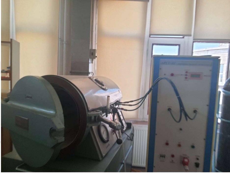
Şekil 5.1. Hipoksi Uygulamasının Yapıldığı Kamara Sistemi
