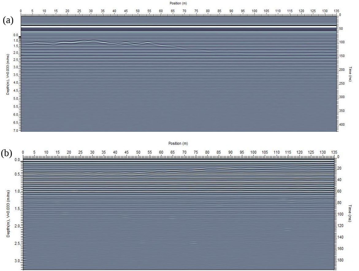
Şekil 4.5 100 MHz (a) ve 500 MHz (b) antenlerle yapılan ölçümlere ait işlenmemiş WPR kesitleri
