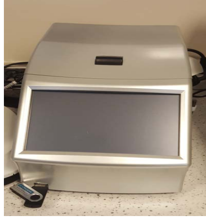
Şekil 3.2 DNA ürünlerini çoğaltmak için kullanılan termal döngü cihazı
