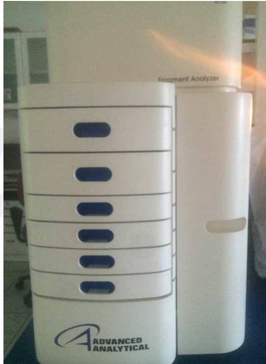
Şekil 3.4 AATI Fragman Analiz Cihazı
