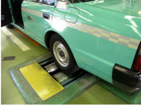
Şekil 3.7 Japonya taksimetre test ekipmanı ( TMII, 2018)
