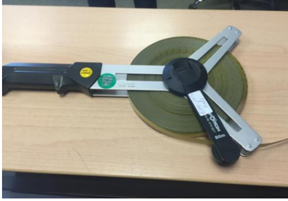
Şekil 3.8 Taksimetre mesafe ölçümünde kullanılan şerit metre ve pist (Çakan, 2016)
