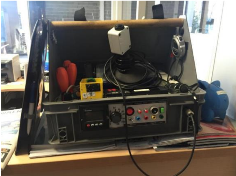
Şekil 3.9 Taksimetre mesafe ölçümünde kullanılan ölçüm cihazı (Çakan, 2016)
