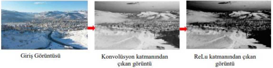
Şekil 2.26 Bir ESA Modelinde Konvolüsyon ve ReLu Katmanının Etkisi
