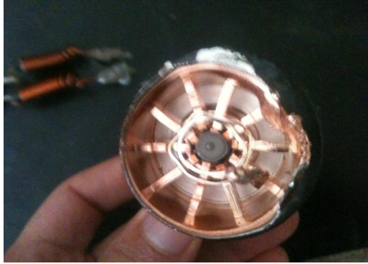
Şekil 2.4 Laboratuvar ortamında içini açtığımız magnetronun kavite yapısı
