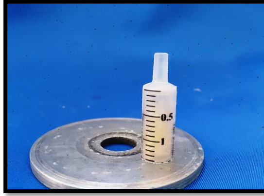
Şekil 2.9. Enjektör kalıbın içerisine epoksi rezin ile birlikte gömülmüş kök.
