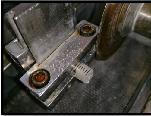
Şekil 2.10. 2 mm kalınlığında su soğutması altında örneklerin kesilmesi
