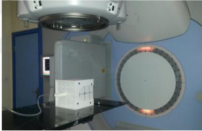
Şekil 4.1 Lineer hızlandırıcı cihazında IBA IMRT küp fantom ölçümleri
