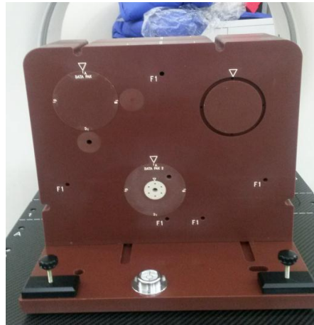
Şekil 4.9 Benchmark IMRT Fantomunda su ve kemik ölçümleri için set-up
