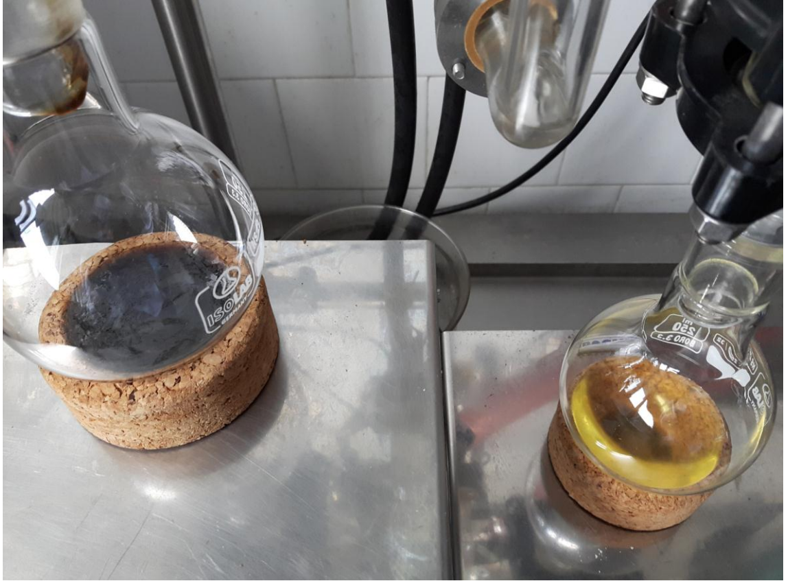
Şekil 4.8 Deodorize distilattan elde edilen fazlara ait görüntüler (sol:atık faz; sağ:distilat faz)
