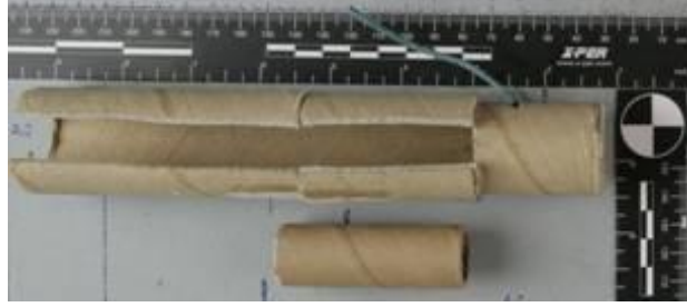
Şekil 3.6. Fişek ve Namlu Kesit Görünümü
