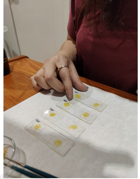
Şekil 3.12 Çiçek tozları ekildikten sonra lamaların üzerine lamel yerleştirilmesi
