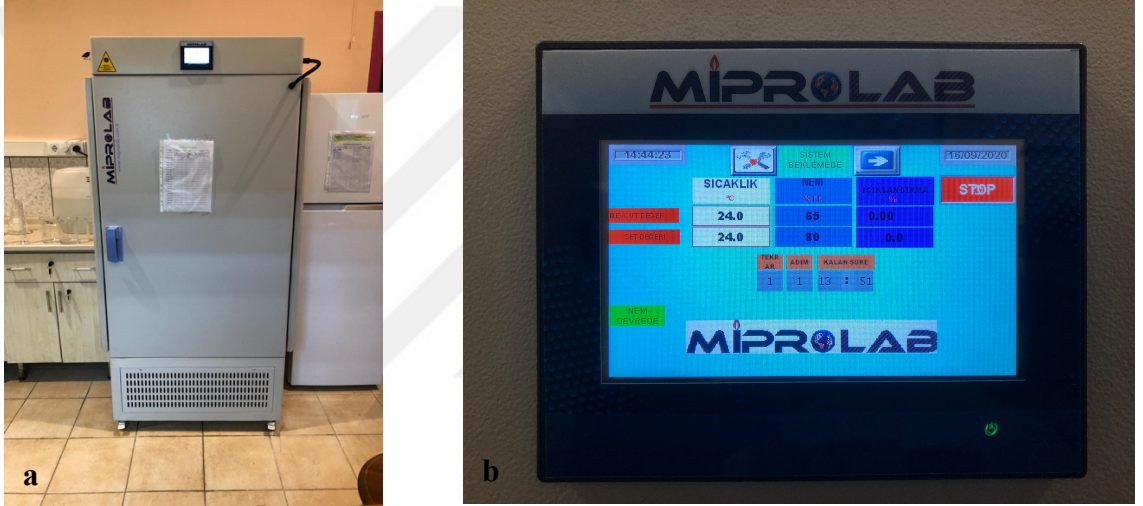
Şekil 3.7 Çiçek tozlarının muhafaza edildiği iklim dolabı (a) ve set değerleri (b)
