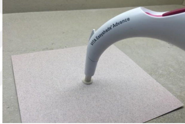
Şekil 2.7. Örneklerin renk değerlerinin spektrofotometre ile ölçülmesi.
