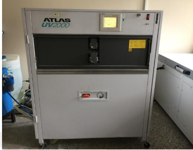
Şekil 2.11. Hızlandırılmış yapay yaşlandırma test cihazı (Atlas UV2000 = Atlas Material Testing Solutions, Mount Prospect, Illinois, ABD).
