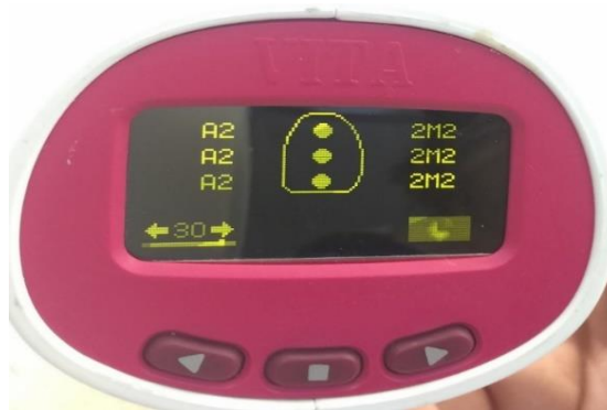
Şekil 2.8. Örneklerin renk değerlerinin spektrofotometre ile belirlenmesi.
