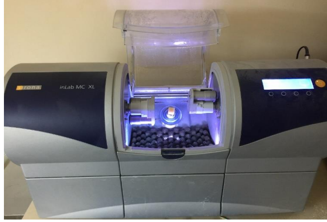
Şekil 2.2. Örneklerin hazırlanmasında kullanılan Cerec 3 inlab (Dentsply, Sirona, Almanya) CAD/CAM sistemi.
