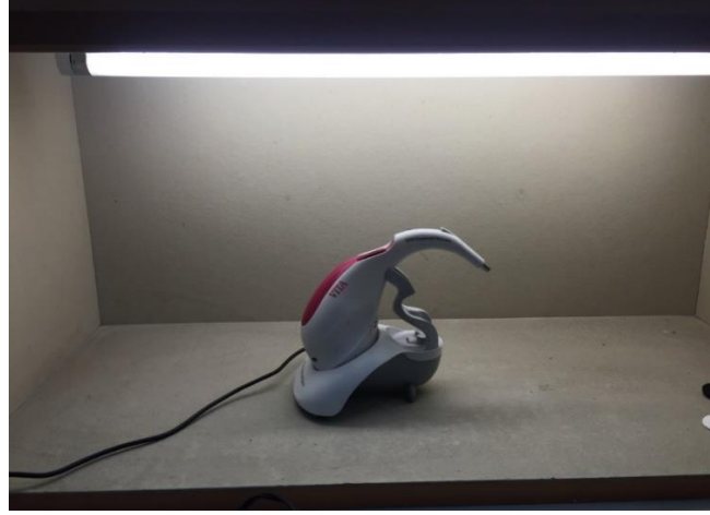
Şekil 2.6. Spektrofotometrik ölçümlerde kullanılan cihaz (Vita Easyshade Advance-VITA Zahnfabrik, Almanya) ve ölçümlerin yapıldığı D 65 ışık kaynağının bulunduğu ölçüm kutusu.
