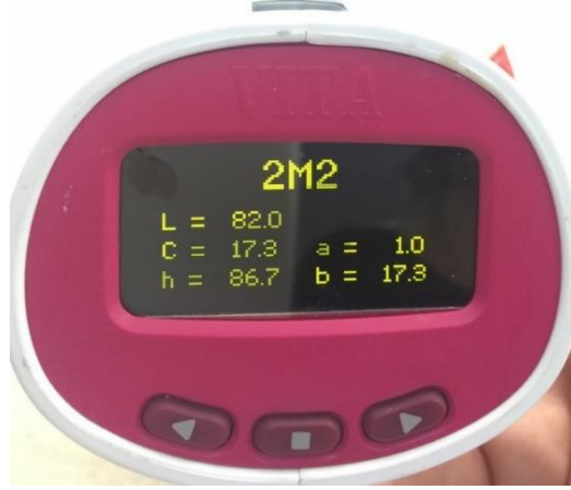
Şekil 2.9. Örneklerin L, a ve b değerlerinin spektrofotometre ile tespit edilmesi.
