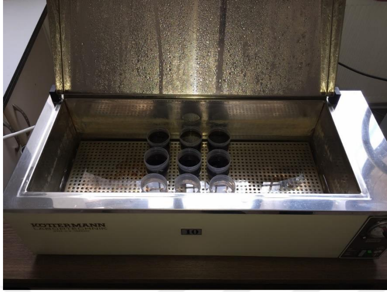
Şekil 2.10. Test örneklerinin, 37°C sıcaklıkta, kahve, şarap ve distile su içinde, 1 gün, 12 gün ve 60 gün gibi belirlenen süreler boyunca bekletildiği inkübatör.
