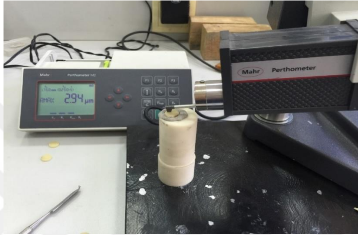
Şekil 2.5. Çalışmamızda kullanılan profilometre cihazı (Perthometer M 2 , Mahr, Almanya).
