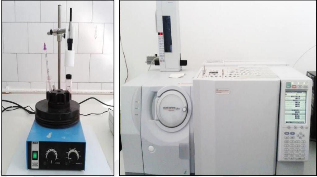
Şekil 3.8 65 µm PDMS/DVB fiber uygulaması ve GC-MS düzeneği
