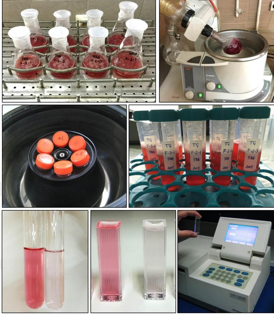
Şekil 3.7 pH farklılığı yöntemi ile antosiyanin tayininin aşamaları
