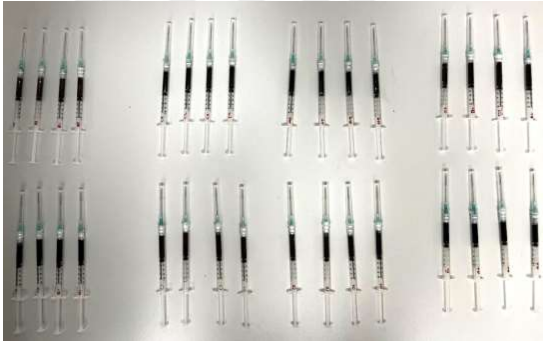
Şekil 4.12 Enjekte edilebilirlik analizi için şırınga içerisine doldurulmuş kompozit manyetik hidrojeller
