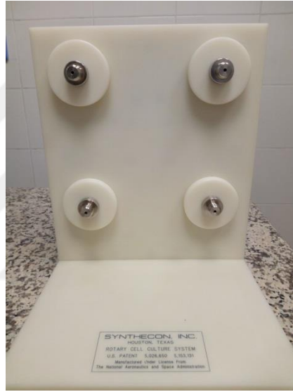
Şekil 1.5. Döner Duvarlı Kap Biyoreaktörü ( ElçinLab )
