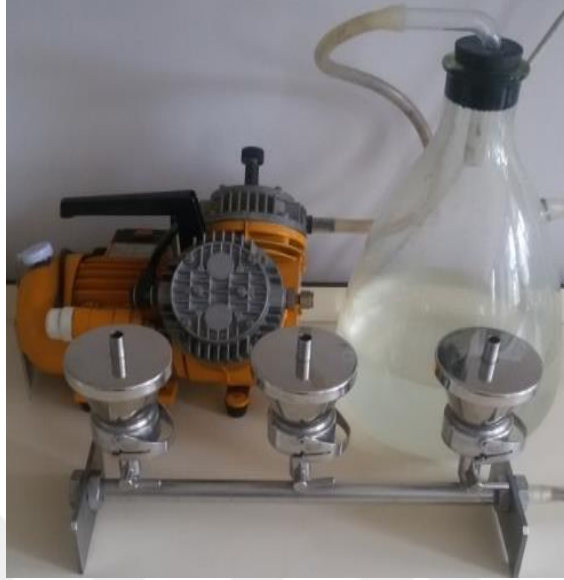
Şekil 3.3 Suların filtre edildiği filtrasyon cihazı
