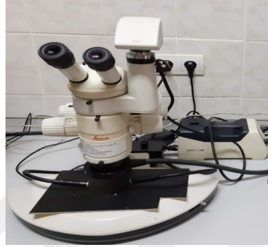
Şekil 2.13. Silikon replika üzerinde ölçümlerin yapıldığı stereo mikroskop (Leica MZ-12, Leica, Almanya)
