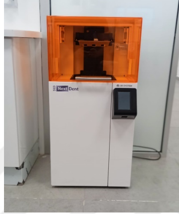
Şekil 2.2. Üç boyutlu modellerin elde edildiği 3B yazıcı cihazı (Nexdent 5100, Nextdent, Hollanda)
