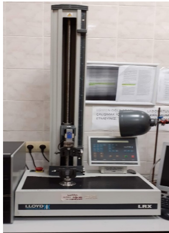
Şekil 2.19. Direnç testlerinde kullanılan üniversal test cihazı (LLOYD LRX, Lloyn Instruments, İngiltere)
