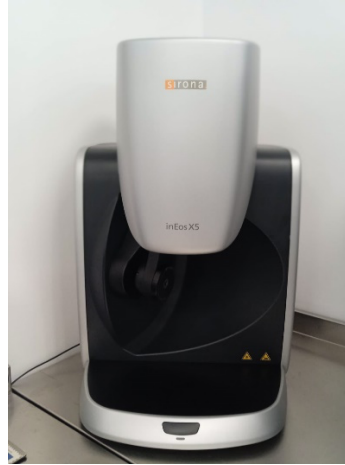
Şekil 2.1. Model taramalarında kullanılan inEos x5 cihazı (Dentsply Sirona, Amerika)
