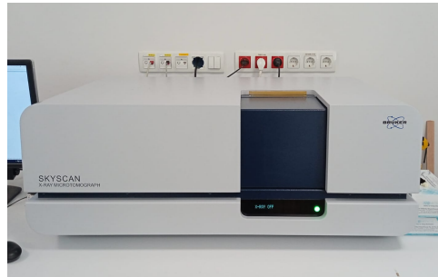
Şekil 2.14. Görüntülemelerin yapıldığı mikro-BT cihazı (Skyscan 1275, Belçika)
