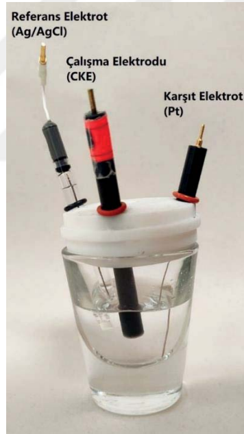
Şekil 2.1. Tez çalışmasında voltametrik analizlerde kullanılan üç elektrotlu hücre sistemi
