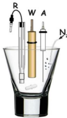
Şekil 1.10. Hücre ve üç elektrotlu sistemin şematize edilmiş hali: referans elektrot (R), Çalışma elektrodu (W), Karşıt elektrot (A)
