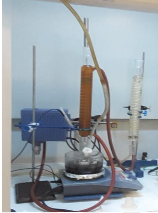
Şekil 3.1 ZnO nanotanicikleri sentez deney düzeneđi
