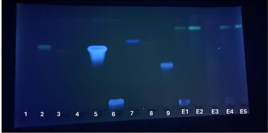
Şekil 3.1. I. anatolica 'nın toprak üstü ve altının farklı çözücülerdeki ekstreleri ve standart bileşiklerin Toluen: Etil asetat: Formik asit: Metanol (40:32:8:1) çözücü sisteminde 366 nm'de Natural Product Reaktifi püskürtmeden önceki İTK kromatogramı - (1: Rutin, 2: Kersetin, 3: Luteolin, 4: Kemferol, 5: Kafeik asit, 6: Klorojenik asit, 7: Ferulik asit, 8: Apigenin, 9 : Rozmarinik asit E1: Toprak altı % 70 etanolü ultrasonik ekstre, E2: Toprak altı etil asetatlı ultrasonik ekstre, E3: Toprak üstü etil asetatlı soxhlet ekstresi, E4: Toprak altı metanolü soxhlet ekstresi, E5: Toprak altı metanolü ultrasonik ekstre)
