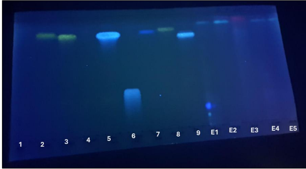
Şekil 3.6. I. anatolica 'nın toprak üstü ve altının farklı çözücülerdeki ekstreleri ve standart bileşiklerin Etil asetat: Metanol: Formik asit: Su (64,5:3,9:3,9:7,7) çözücü sisteminde 366 nm'de Natural Product Reaktifi püskürttükten sonraki İTK kromatogramı - (1: Rutin, 2: Kersetin, 3: Luteolin, 4: Kemferol, 5: Kafeik asit, 6: Klorojenik asit, 7: Ferulik asit, 8: Apigenin, 9 : Rozmarinik asit E1: Toprak altı % 70 etanolü ultrasonik ekstre, E2: Toprak altı etil asetatlı ultrasonik ekstre, E3: Toprak üstü etil asetatlı soxhlet ekstresi, E4: Toprak altı metanollü soxhlet ekstresi, E5: Toprak altı metanollü ultrasonik ekstre)
