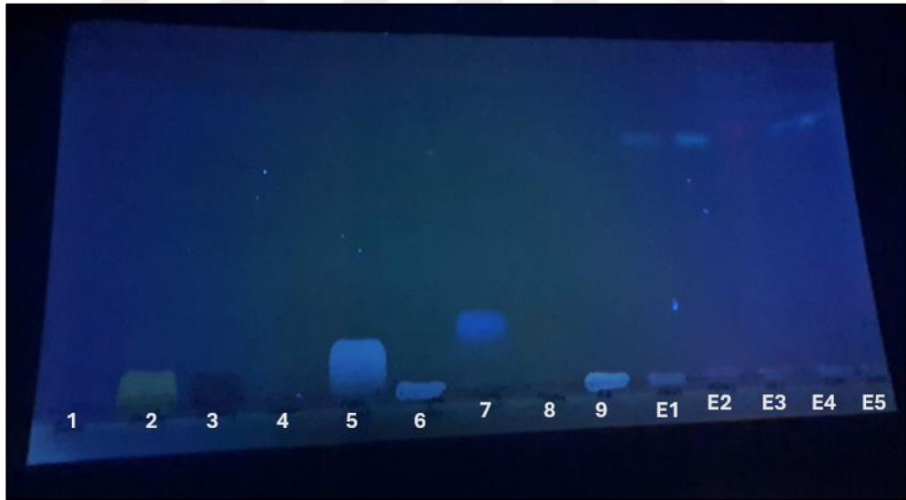
Şekil 3.3. I. anatolica 'nın toprak üstü ve altının farklı çözücülerdeki ekstraktları ve standart bileşiklerin Hekzan: Etil asetat (48:32) çözücü sisteminde 366 nm'de Natural Product Reaktif püskürtmeden önceki İTK kromatogramı - (1: Rutin, 2: Kersetin, 3: Luteolin, 4: Kemferol, 5: Kafeik asit, 6: Klorojenik asit, 7: Ferulik asit, 8: Apigenin, 9 : Rozmarinik asit E1: Toprak altı % 70 etanollü ultrasonik ekstre, E2: Toprak altı etil asetatlı ultrasonik ekstre, E3: Toprak üstü etil asetatlı soxhlet ekstresi, E4: Toprak altı metanollü soxhlet ekstresi, E5: Toprak altı metanollü ultrasonik ekstre)
