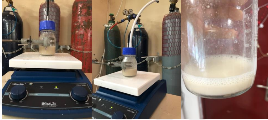
Şekil 3.5 Karbonizasyon deney düzeneği
