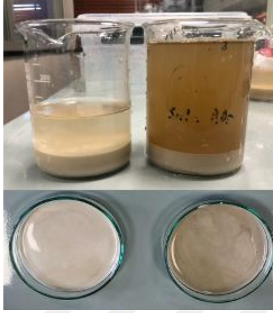
Şekil 4.30 Fosfojipsin optimum koşullarda (8 M H 2 SO 4 derişimi, k/s=1/10, T=75°C) saflaştırma öncesi ve sonrasına ait fotoğraflar
