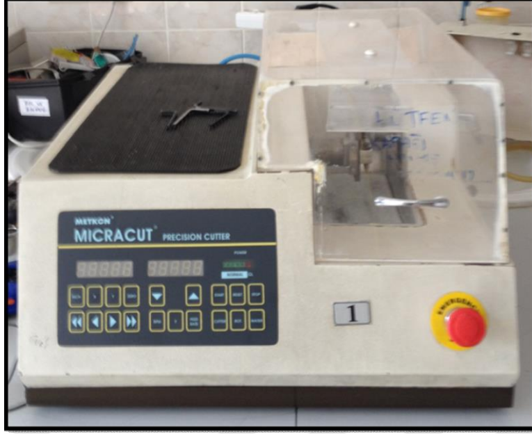
Resim 2.1. Kronu kesmek için kullanılan su soğutmalı kesme cihazı
